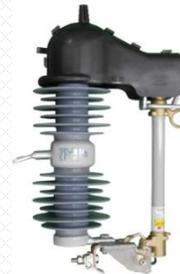
안전기라고도 하며, 전기 기계의 회로에 일정량 이상의 전기가 흐를 때에, 전기 기계의 파손 및 화재를 막기 위하여 전기 회로 가운데에 끼우는 기구. 주상변압기 1차 측에 부착되며, 당사의 제품은 상하부 절연커버를 동시에 열고 사용하여 외물 접촉 고장을 예방함.
