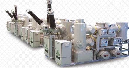
SF6 가스를 이용하여 폭930mm의 크기로 축소하여 설치면적 최소화 하였으며, 충전부위가 접지된 탱크에 내장되어 감전위험이 없음. 특히 아크에너지를 이용한 복합소호형 차단방식 채택으로 듀얼모션 구조로 적용되는 것이 특징임.
